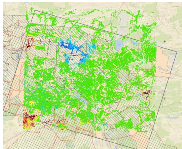
Großräumige Messung und Bewertung von Bodenbewegungen in Bergbaugebieten unter Nutzung von GNSS und InSAR
